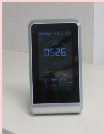
CO 2 モニターによる 換気の確認
