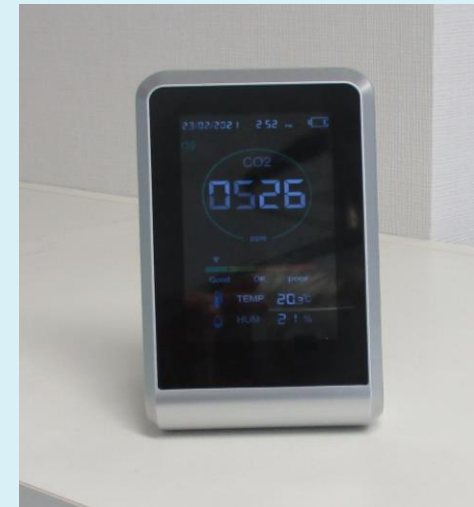
CO 2 モニターによる 換気の確認
