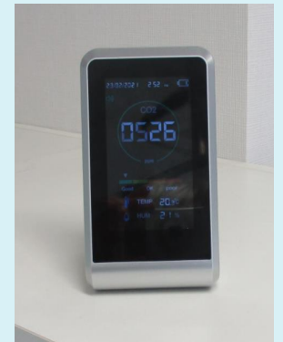
CO 2 モニターによる換気の確認
